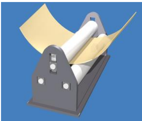
Slika 1. Mehanička presa sa tri valjka za kružno savijanje lima
